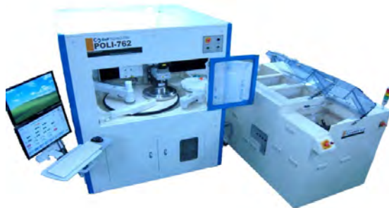
개발된 12인치 웨이퍼 평탄화용 CMP 장치 및 후세정장비
