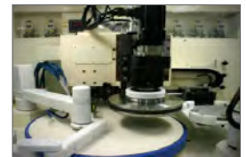
대면적 웨이퍼(18인치) CMP를 위한 장비 및 공정기술 : 균일 가압 및 속도를 갖는 회전형 독립구조 장비
